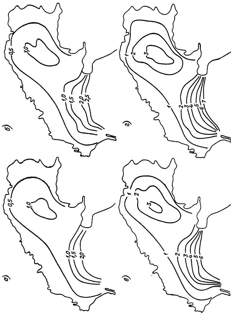
Рис. 1.23. Средняя высота волн \bar{h} (м), возможная 1 раз в год (а) и в 50 лет (б), и максимальная высота волн h_{0.1\%} (м), возможная 1 раз в год (в) и в 50 лет (г).
