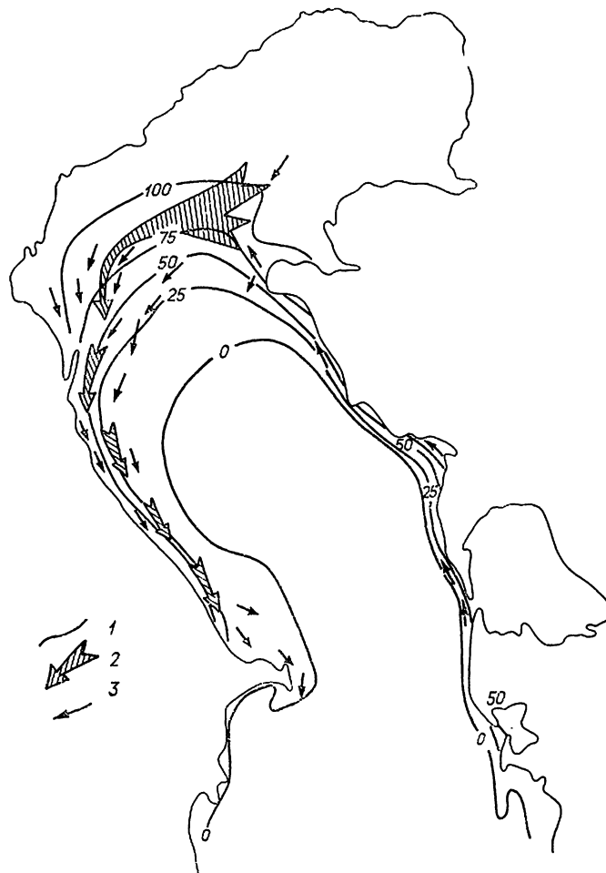
Рис. 8.1. Вероятность ледообразования (наличие льда) и схема дрейфа плавучего льда.
