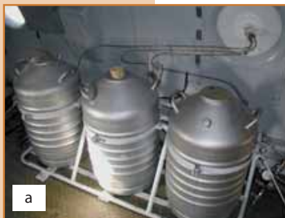
Самолётный генератор мелкодисперсных частиц льда - ГМЧЛ-А, (а- ГМЧЛ-первого поколения, б- второго).
