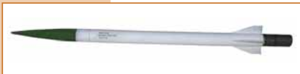
Маршевая ступень метеорологической ракеты «Мера» с теплозащитным покрытием корпуса.
