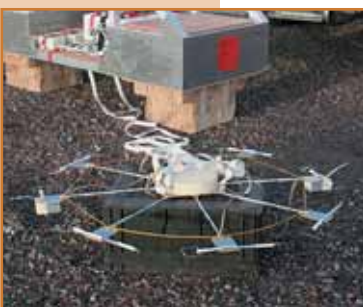
Аппаратура для тестирования датчиков радиозондов на земле (снимок слева) и в полёте (снимок справа).
