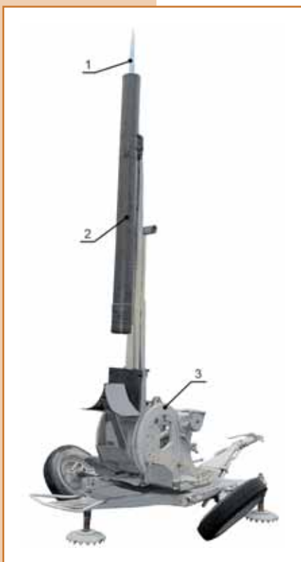
1 – маршевая ступень, 2 – контейнер со стартовой ступенью, 3 – пусковое устройство Метеорологическая ракета «Мера» в составе мобильной пусковой установки.
