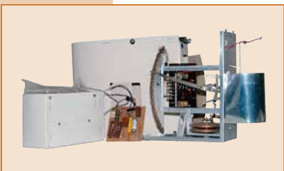
Гребенчатый радиозонд РЗ-049М (усовершенствованный вариант первого радиозонда Молчанова). Изготавливался в различных модификациях с 30-х по 50-е годы XX века.
