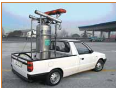
Наземные генераторы мелкодисперсных частиц льда – стационарный и передвижной.
