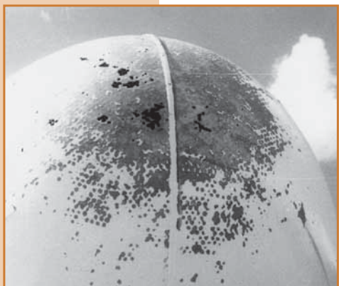
Носовой обтекатель СМЛ ИЛ-18 «Циклон» после встречи с тропическим штормом Эмили. Куба, сентябрь 1987 г. (Фото Н.С. Рябцева).
