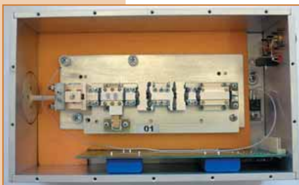
СВЧ радиометры диапазона 60 ГГц (слева - прямого усиления, справа - супергетеродинный)
