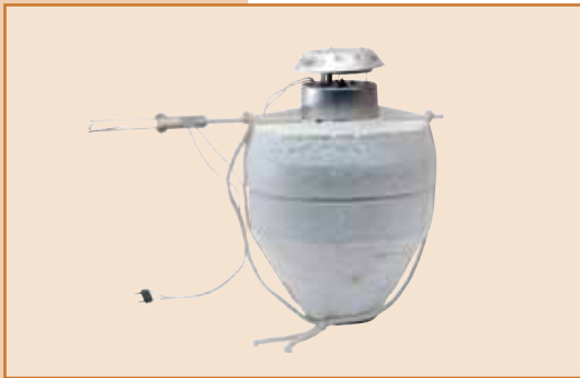
Радиозонд МР3-3А. Изготавливается с 80-х годов XX века.
