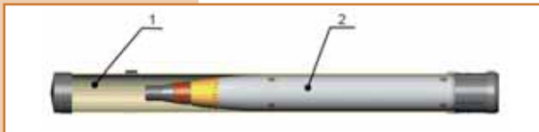
1 – контейнер, 2 – стартовая ступень Стартовая ступень метеорологической ракеты «Мера» в транспортно-пусковом контейнере.
