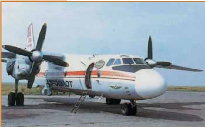
Самолёт-метеолоборатория для активных воздействий на облачные системы АН-26Б № 26408 «Циклон» (слева) и ИВК «Циклон-01» СМЛ АН-26Б «Циклон». 1986 г. (справа).
