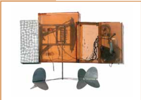
Гребенчатый радиозонд П.А.Молчанова (внутреннее устройство). Изготовлен в Институте аэрологии ГГО в 1929-1930 г.г. (Фото из музея ГГО).
