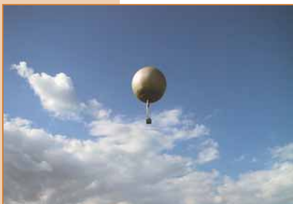
Аэростат СССР ВР-106. Использовался в ЦАО для исследования атмосферы.
