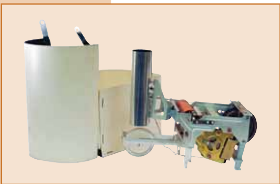
Радиозонд А-22-IV. Изготавливался с конца 60-х по 80-е годы XX века.
