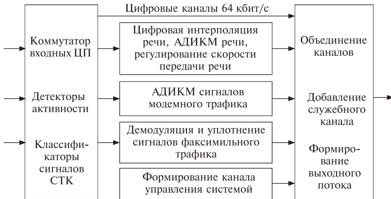
Рис. 7.9. Обобщенная схема формирования потока в оборудовании ЦИР-АДИКМ
