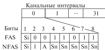
Рис. 10.1. Структура сигналов FAS и NFAS
