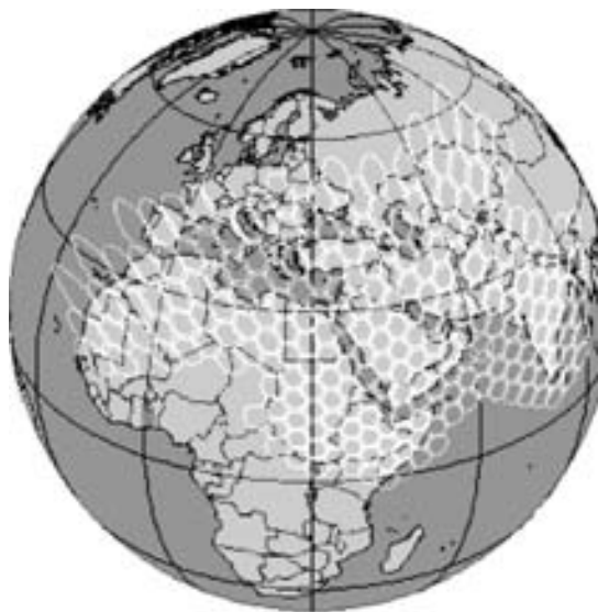
Рис. 9.5. Зона покрытия ИСЗ связи Thuraya
