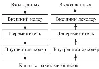
Рис. 6.15. Применение перемежения при каскадном помехоустойчивом кодировании
