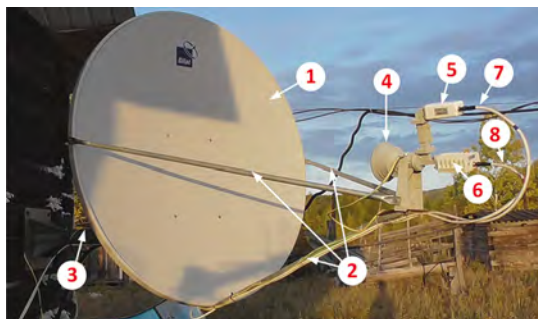
Рис. 8. Внешнее оборудование станции VSAT.
