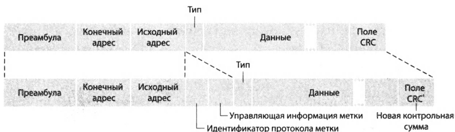
Рис. 5.27. Исходный кадр Ethernet (вверху) и VLAN-кадр Ethernet, снабженный меткой стандарта 802.1Q (внизу)
