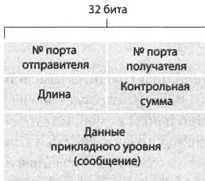
Рис. 3.7. Структура UDP-сегмента
