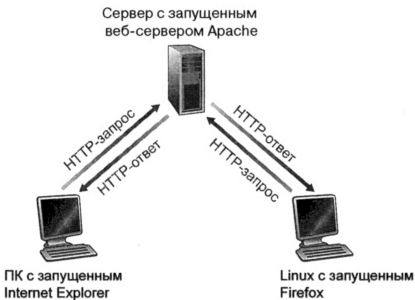
Рис. 2.6. Процедура запросов и ответов HTTP
