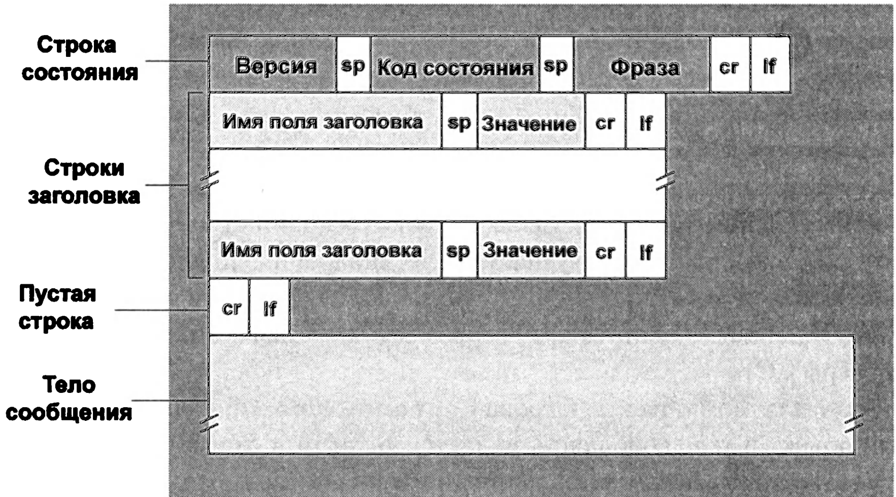
Рис. 2.9. Общий формат сообщения-ответа протокола HTTP
