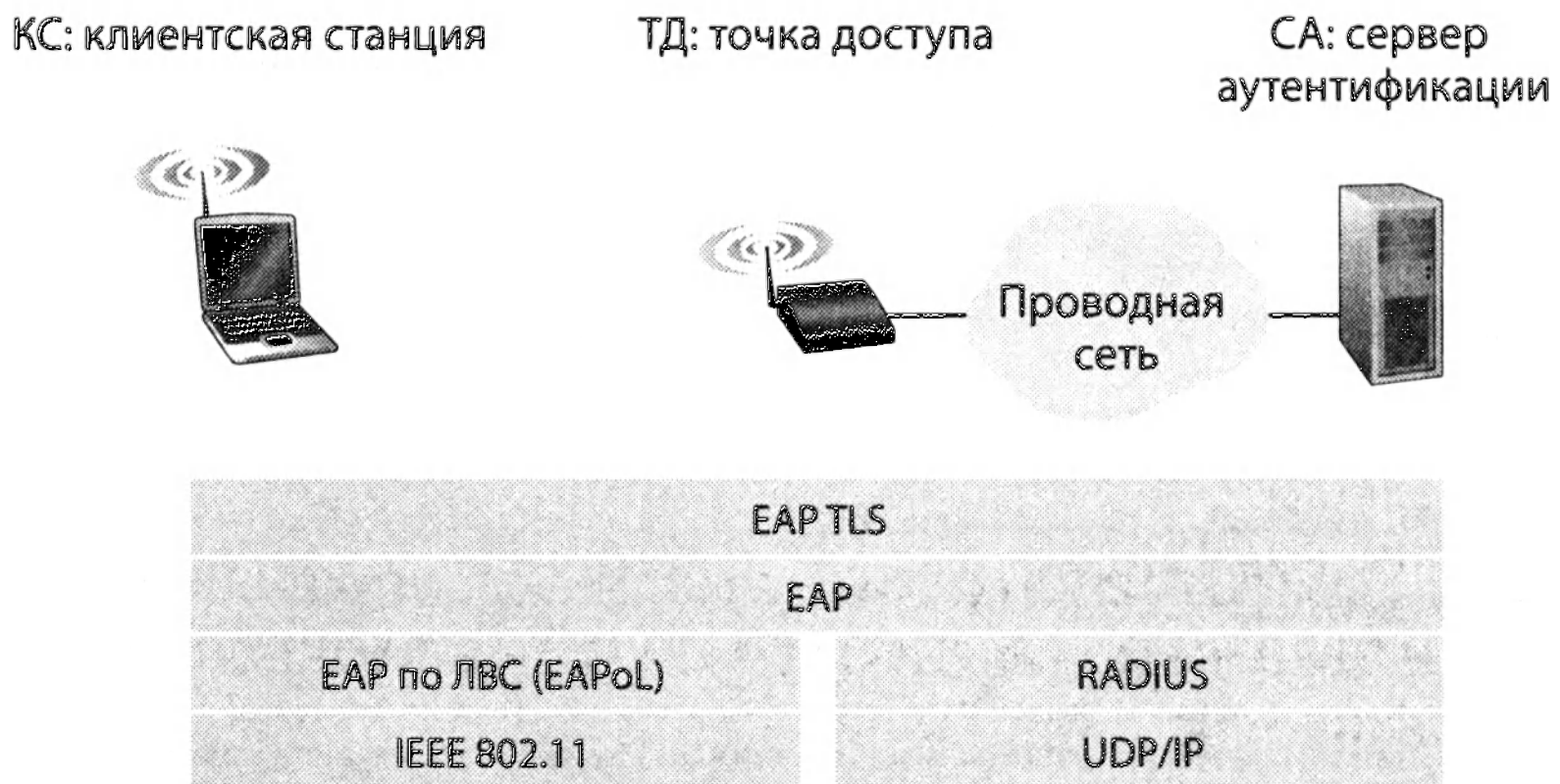
Рис. 8.32. EAP — «сквозной» протокол. Сообщения EAP инкапсулируются при помощи протокола EAPoL и передаются по беспроводному каналу между клиентом и точкой доступа, а при помощи протокола RADIUS — по UDP/IP между точкой доступа и сервером аутентификации
