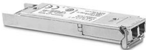
Рис. 1.10. Модуль XFP DEM-423ХТ с одним портом 10GE (10GBASE-ER) для одномодового оптического кабеля
