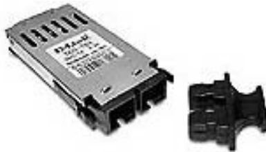
Рис. 1.7. Модуль GBIC DGS-703 с одним портом 1000Base-LX для одномодового оптического кабеля
