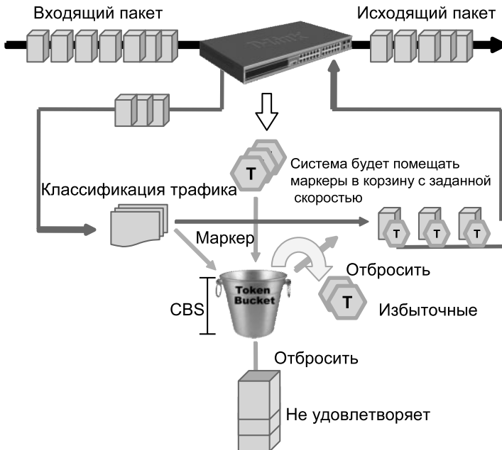
Рис. 6.9. Алгоритм «корзина маркеров» в рамках механизма Traffic Policing
