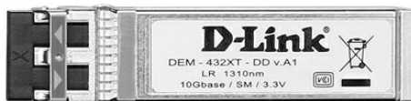
Рис. 1.11. Модуль SFP+ DEM-432XT-DD с одним портом 10GE (10GBASE-LR) для одномодового оптического кабеля и поддержкой функции цифровой диагностики
