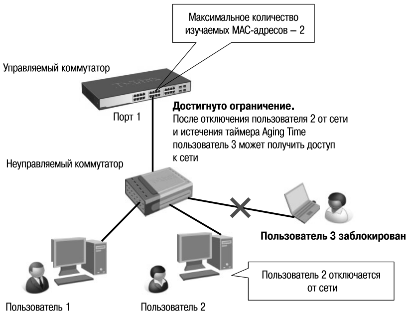
Рис. 7.7. Функция Port Security в режиме Delete on Timeout
