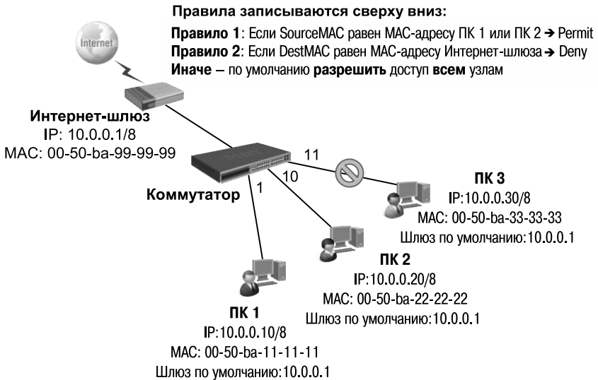
Рис. 7.4. Пример ACL для профиля Ethernet
